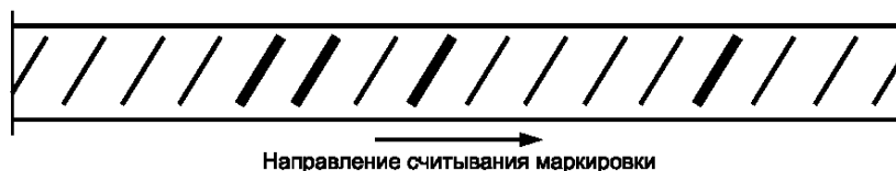
Рисунок 2 — Пример прокатной маркировки предприятия-изготовителя под номером 14
